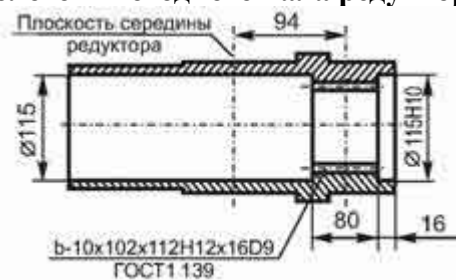
Размеры полого тихоходного вала редуктора 1Ц2У-250
