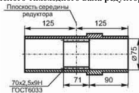
Размеры полого тихоходного вала редуктора 1Ц2У-200
